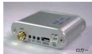
GNSS：センサコム社製 SCR-u2C(u-blox モジュール)
